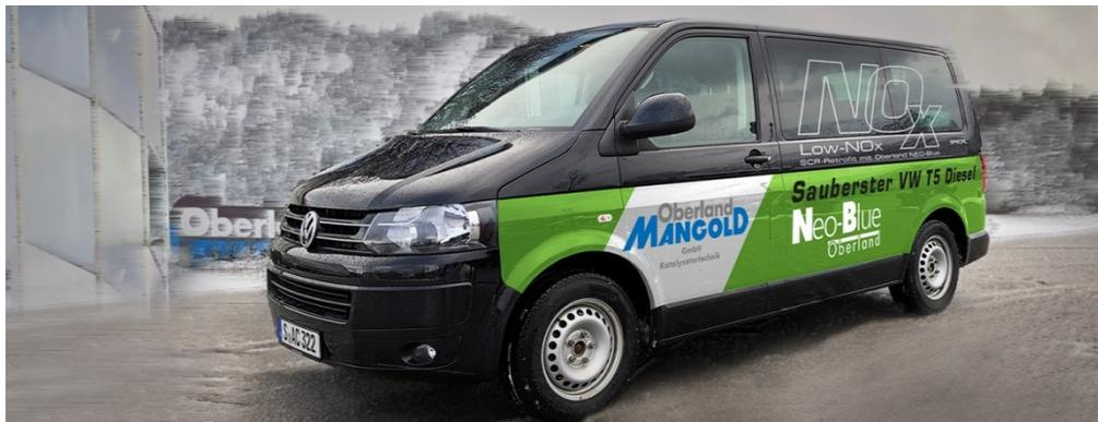
Es ist soweit: Mit seinem SCR-Nachrüstsystem NEO-Blue präsentiert Oberland die dringend erforderliche Lösung zur Stickoxidreduktion gebrauchter EURO5 und EURO6 Diesel-PKWs bzw. leichter Nutzfahrzeuge. Mit NEO-Blue nachgerüstete Dieselfahrzeuge reduzieren den NOx-Ausstoß im realen Fahrbetrieb um bis zu 70 %. Vor allem im Stadtbetrieb, wo die NOx-Schadstoffbelastung am höchsten ist, zeigt NEO-Blue seine beste Performance.
